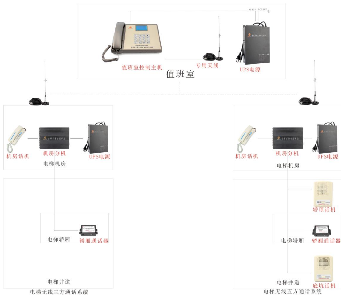
数字电梯无线对讲系统图示
